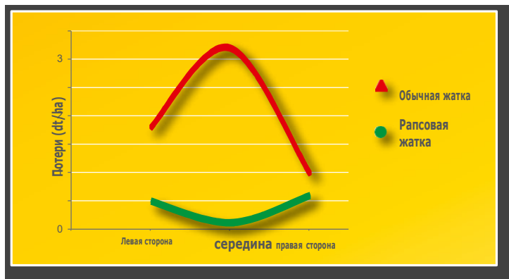
Зоны жатки, где происходят потери зерна
